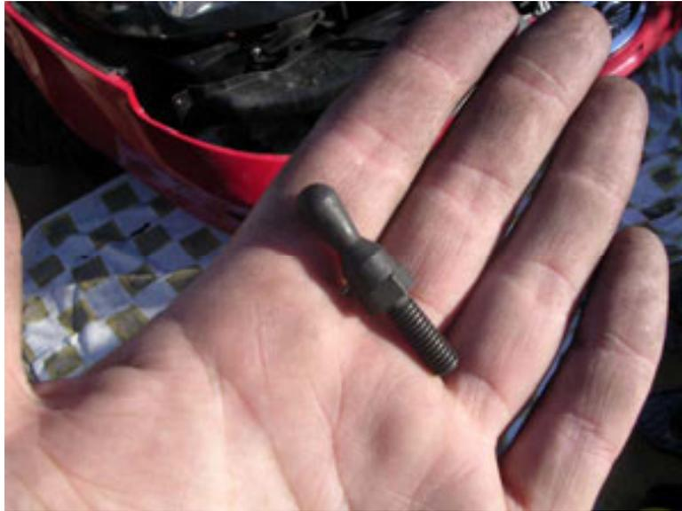
Estos tornillos como he dicho irían a la altura de donde iban los tornillos de las tapetas. Se aprietan con una llave fija y quedarían montados así:
