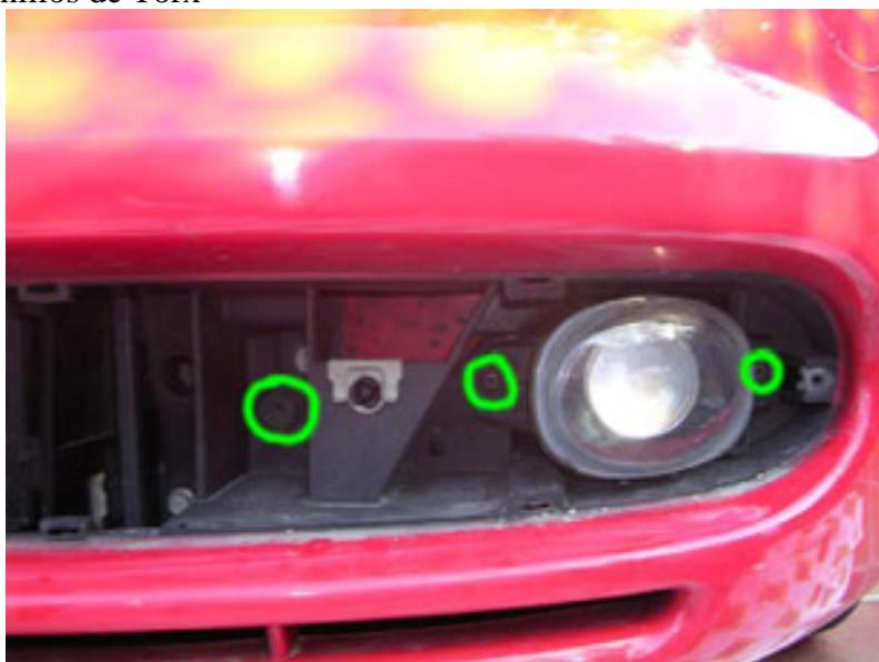
Una vez quitados los tornillos de sujeción del antiniebla sacamos el antiniebla tirando de el con **MUCHO CUIDADO** para no romper las grapas del conector. Cuando se saque el antiniebla nos encontraremos con el típico modelo de grapa SEAT al que se ha de meter un destornillador plano por la ranura de la grapa y así desbloquearla y poder sacar el conector sin dificultad.
