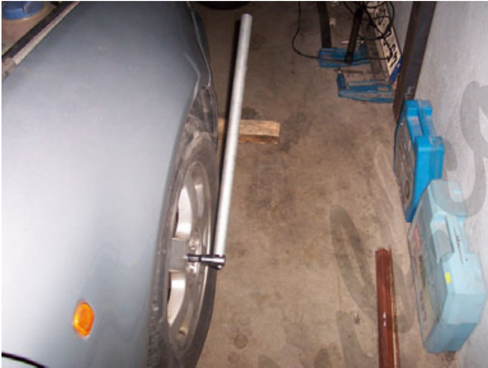
Para aflojar la tuerca del palier...
