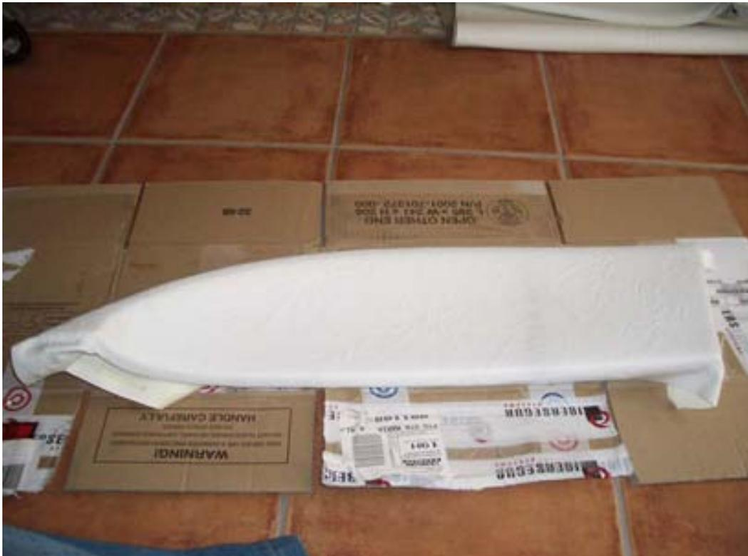
Con la trasera igual, solo que una vez pegados, recortaremos bien la forma del tirador con el cutter para que queden bien fijados los bordes.
