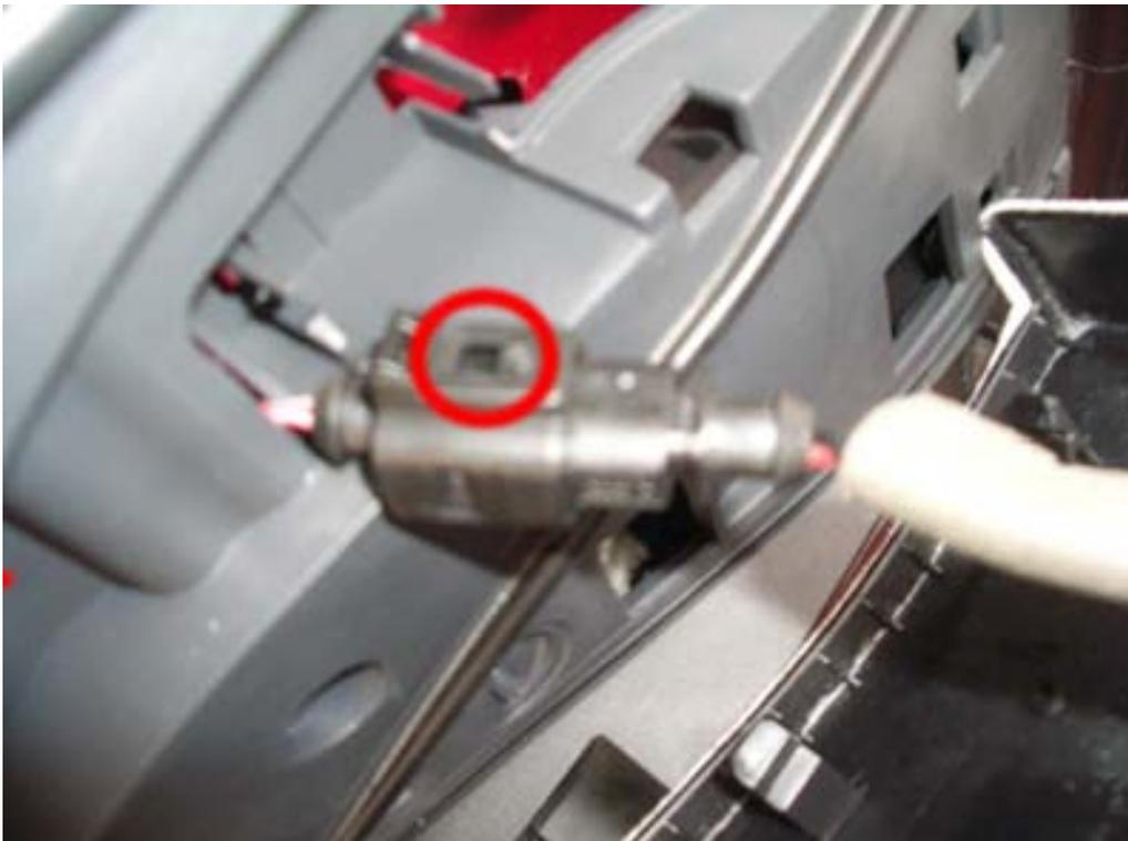
Para el tirador, primero desencajamos la pieza negra (1) que tiene 2 patillas y luego tiramos del cable para desencajarlo del conducto. Después, sacamos del aro la pieza de metal (2).
