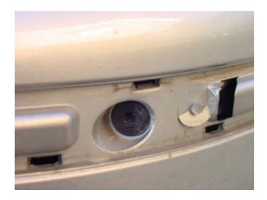
Bajo el embellecedor, cercano a los antinieblas, se esconden otros dos tornillos Torx. Esta tapa se extrae tirando un poco con la mano, no hacen falta herramientas, además tiene un sistema de retención para que no caiga.
