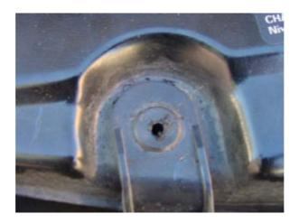
El siguiente paso a realizar será quitar los 3 tornillos Philips de la zona del cubre cárter, estos no tienen ninguna complicación, aunque es posible que falte algún tornillo de esta zona, ya que suelen arrancarse cuando el parachoques queda enganchado en algún bordillo.
