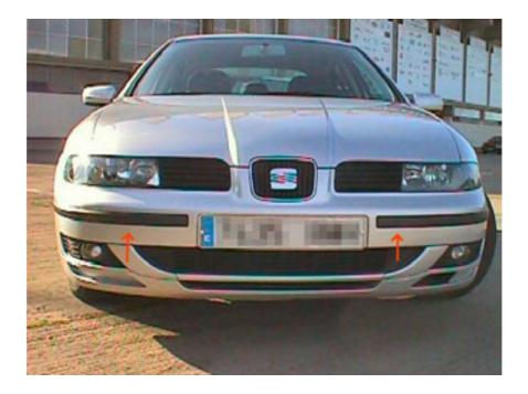
Estos plásticos estan sujetos mediante grapas, la pieza tiene unos dientes en las partes superior e inferior que encajan a presión, pero no se debe tirar de ellos directamente ya que se parten y no se pueden cambiar. En el caso de que se rompan varios hay que sustituir la pieza completa.
