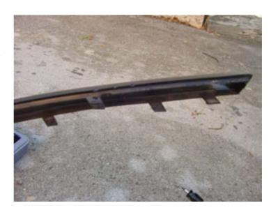
Usando un destornillador fino, en la parte superior del plástico se puede hacer un poco de palanca y la pieza saldrá de su sitio. Como podéis ver, el plástico se queda marcado si se ejerce demasiada presión o se usa un destornillador demasiado grande. La imagen inferior corresponde al protector del lado derecho en la zona más próxima a la matricula.
