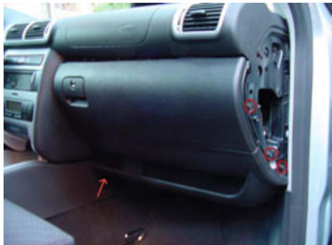
Extraemos la guantera desconectando el cable de iluminación y el del interruptor del airbag en caso de tenerlo. Si se quita este cable es importante sacar el interruptor de la guantera y colocarlo como si no se hubiese manipulado. Ya que si se da el contacto del coche y el interruptor no esta en su sitio se registrara un error en la centralita del león dejando en el salpicadero la luz encendida de manera fija.
