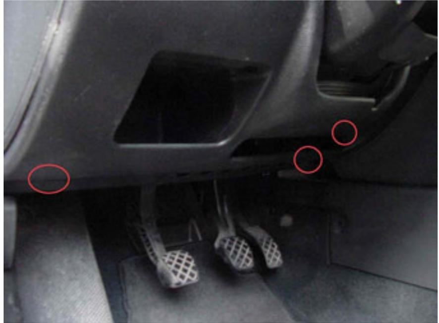
Y por ultimo soltamos las grapas en la parte superior del guarnecido. Desconectando el mando de las luces y el reóstato.,
