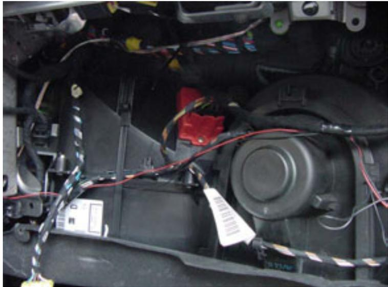
Para desmontar el lado izquierdo, quitamos los tres tornillos marcados en la imagen, que se encuentran dentro de la caja de fusibles.
