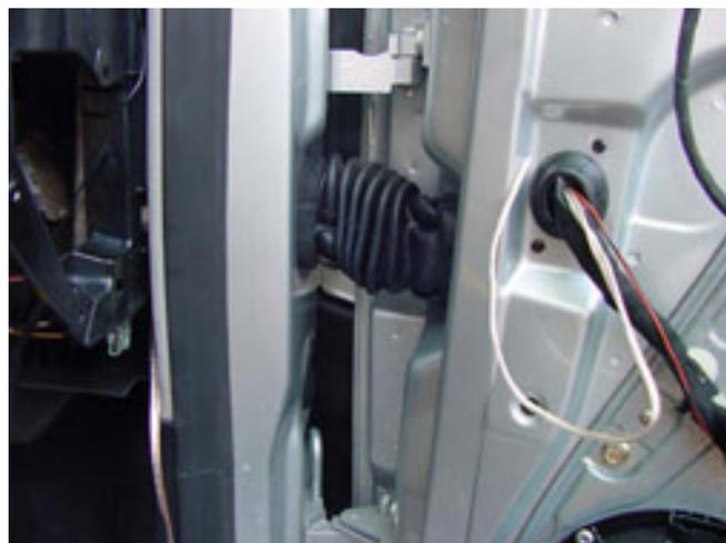
Vamos fijando el cable por la parte superior sujetándolo con bridas, llevando el cable hacia la zona de la consola central.
