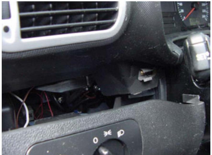
Igual que hemos hecho con el lado derecho colocamos el cable del lado izquierdo a la vez que llevamos otro cable con la alimentación hacia la consola central.
