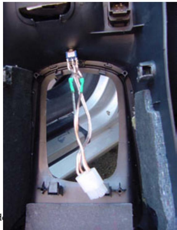
El acabado final es el siguiente. El conector se esconde dentro de la zona del cambio, y una vez colocado el cuero de la palanca de cambio este es el resultado final.
