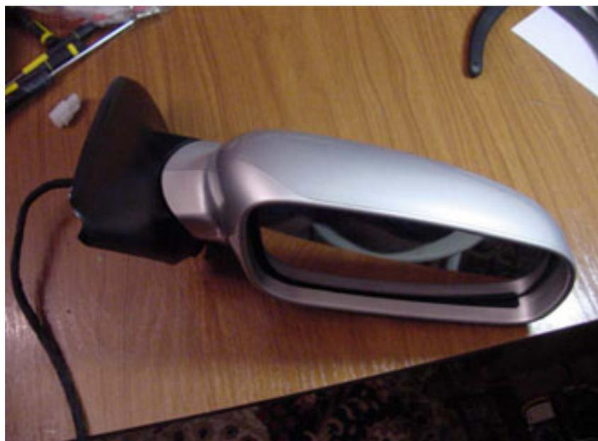
Como podréis observar, el conector esta numerado. Debemos de cortar los cables correspondientes a los números 1,2, 4 y 7. En el pin 2 hay dos cables marrones, hay que cortar el que va conector al final de carrera que se encuentra en la base del espejo, aunque si se quiere se puede dejar este cable sin cortar, ya que no afectara al sistema. En el pin 7 también hay dos cables, debemos cortar el de color rojo/negro.
