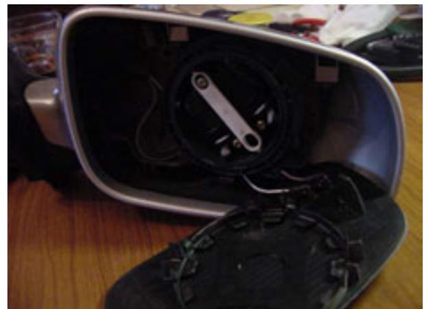
Desconectamos los cables del control térmico del espejo y quitamos la carcasa plástica.
