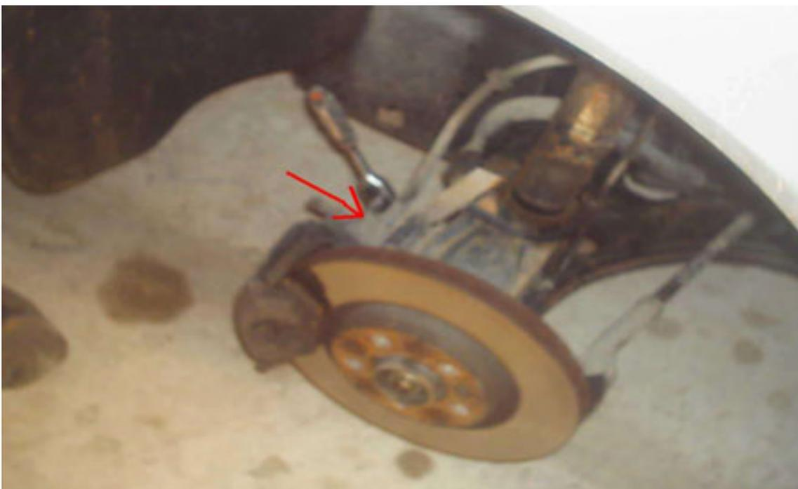
Una vez quitados los dos tornillos les sacaremos un poco para sacar la parte de la pinza que sujeta la pastilla. Para sacar el sujeta pastillas tiraremos de la parte trasera hacia la parte delantera haciendo palanca con un destornillador o algo parecido con mucho cuidado.
