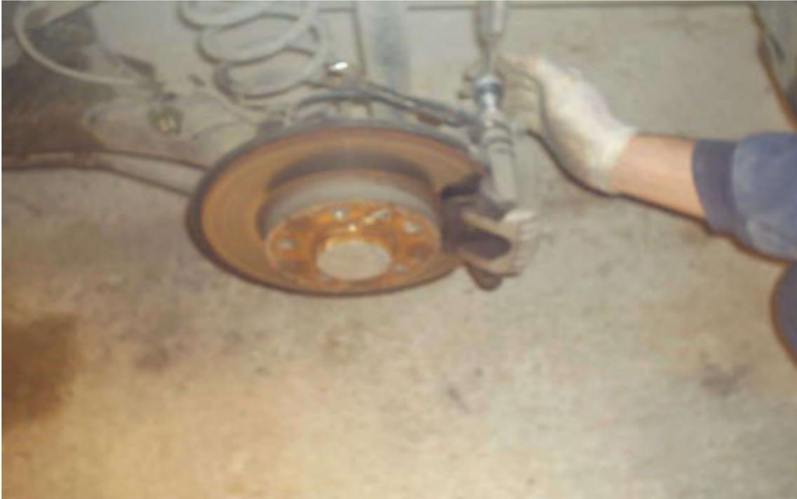
para sacar el porta pastillas tiraremos de delante hacia atrás poco a poco ya que este es más difícil que el delantero iremos tirando una de arriba otra de abajo y seguiremos así, para cambiar el disco trasero igual que el delantero soltaremos el tornillo de estrella.
