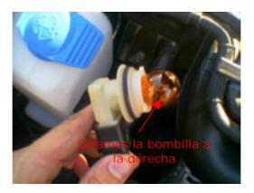
Ahora vamos a sustituir la luz de cruce (corto alcance) H7 y las largas (largo alcance) H1. Debemos quitar la tapa que recubre la caja de las luces, para ello retirar las dos varillas metálicas que están sobre la caja y sacar la tapa.
