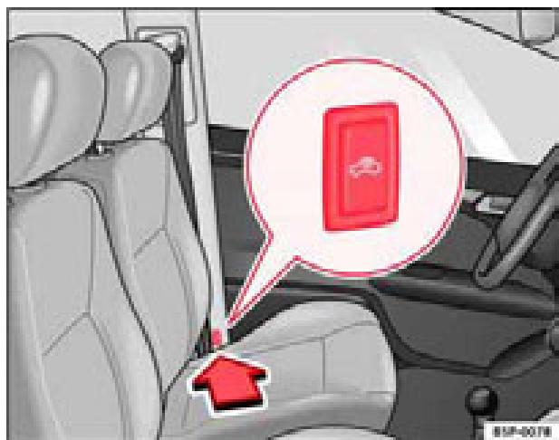
Fig. 65 Tecla para desconectar la vigilancia interior del habitáculo
