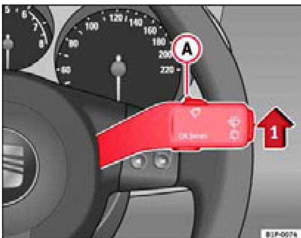
Fig. 84 Palanca del limpiaparabrisas
