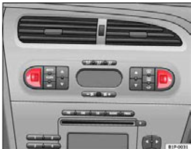
Fig. 92 Ruedecillas moleteadas de la calefacción de los asientos delanteros
