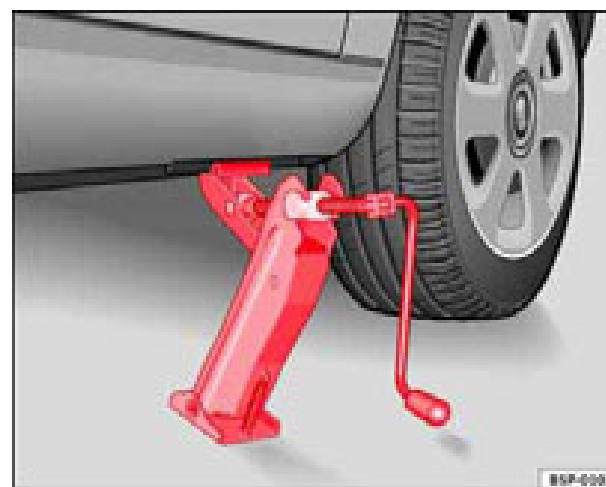
Fig. 150 Colocación del gato
