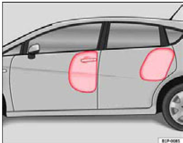
Fig. 22 Airbags laterales completamente inflados en el lado izquierdo del vehículo
