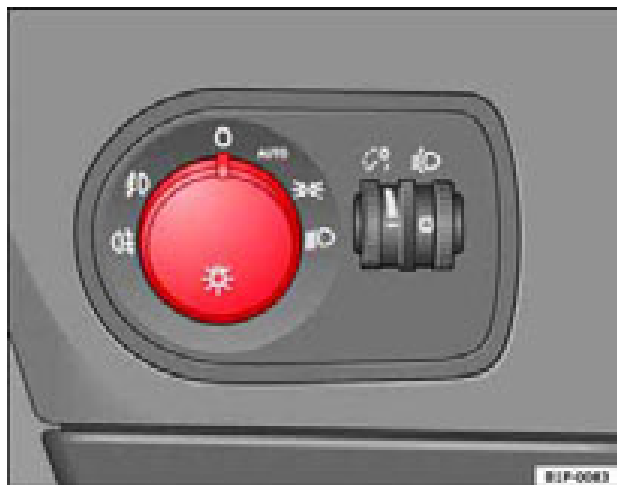
Fig. 74 Encendido automático de luces
