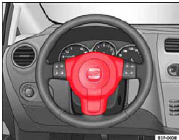
Fig. 17 Airbag del conductor en el volante
