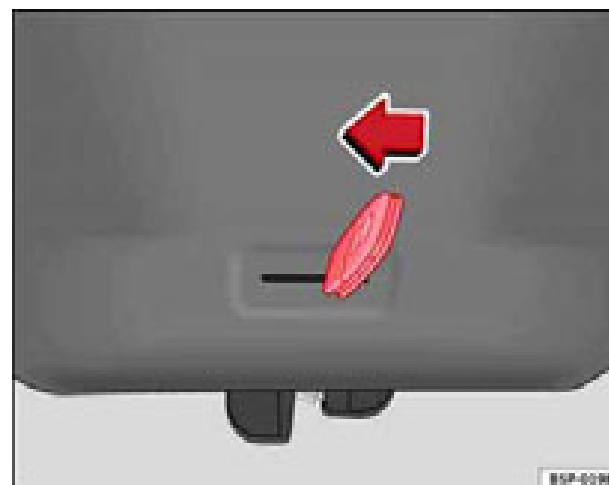
Fig. 68 Portón trasero: apertura de emergencia
