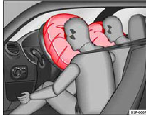
Fig. 19 Airbags frontales inflados
