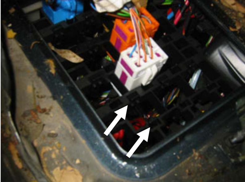
Una vez que tengamos el conector dentro, hay que conectar los cables al conector. Para ello hay que liberar previamente el sistema de seguridad violeta del conector. Para ello presionamos la especie de T hacia adentro hasta que suene CLACK
