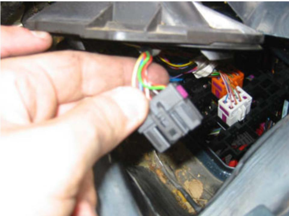
si ahora os fijais, tendremos un conector en la mano, y otra en la especie de pieza de plastico negro. Nuestros cables van conectados al conector que esta en la pieza de plastico negro. Yo lo que hice aquí fue meter el conector para adentro, y ya una vez dentro enchufar ahí los cables. Para meter para dentro el conector, solo hay que empujarlo hacia adentro, al mismo tiempo que liberamos las pestañas de sujeción que lleva. Las pesatañas de sujeción son las que se ven en la siguiente figura.
