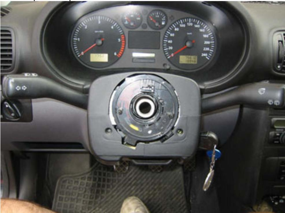
Vale, ahora toca desmontar todos los plasticos de alrededor del volante, y la parte que cubre los pies del conductor para poder acceder a los cables necesarios.
